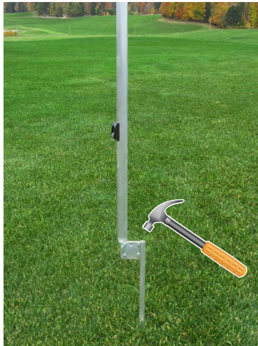
5. Standrohr auf den Bodenanker aufstecken und einschlagen, mit aufgesetztem Standrohr lässt sich der Bodenanker leichter gerade einschlagen
