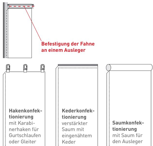
Auslegerseitige Befestigungen lassen sich frei mit mastseitigen Befestigungen kombinieren.
